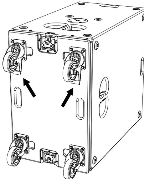
Abbildung 4.1.1 - Transportaufbau B30 Lautsprecher mit FDB30
